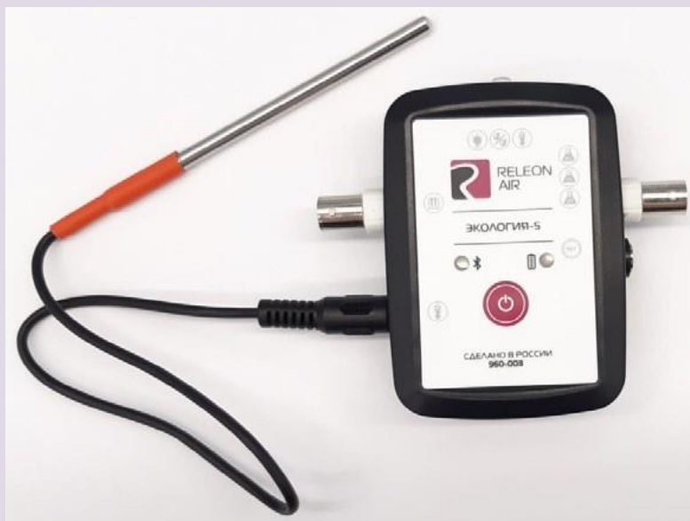
Рис. 6. Датчик температуры растворов
